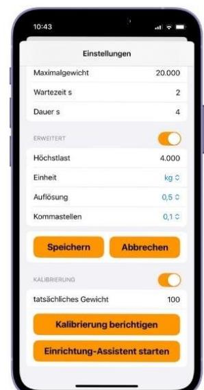
Wenn Sie eine bestehende Waage mit dem BW1-Modul nachrüsten, können Sie mit dem Einrichtungs-Assistent alle notwendigen Schritte zur Kalibrierung durchführen, und die relevanten Einstellungen setzen. Dieser Einrichtungs-Assistent wird automatisch gestartet, wenn Sie die app mit einem Modul verbinden, dass noch nie eingerichtet wurde oder wenn die app erkennt, dass Daten nicht ordnungsgemäß sind.
